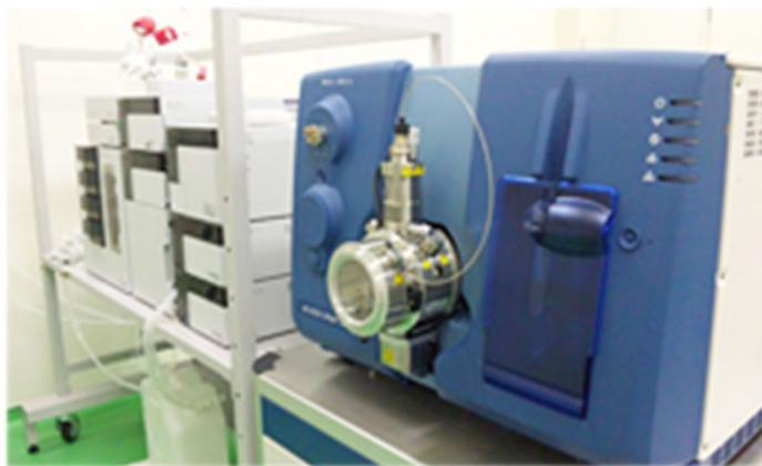
LC-MSMS ※ 1mg以下/錠の製剤の同等性試験には検出感度の高いLC-MSMSが望ましい
